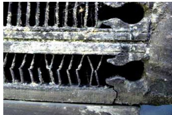
Kühlerausfall durch Spannungsrisse
